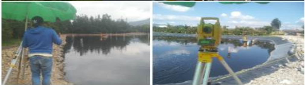
Levantamiento topográfico y batimétrico
