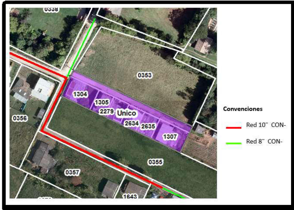
Imagen8. Red de alcantarillado combinado
