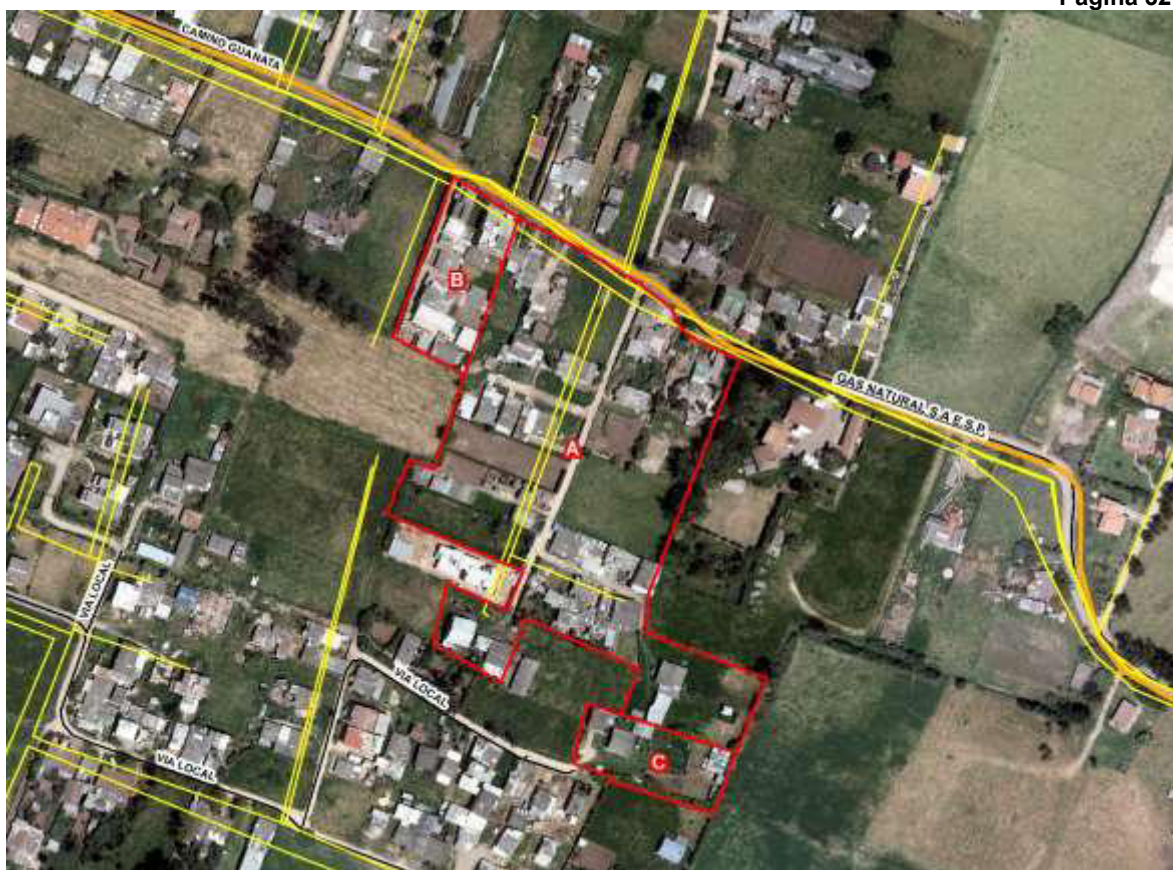
Ilustración 17. Redes de gas domiciliario
