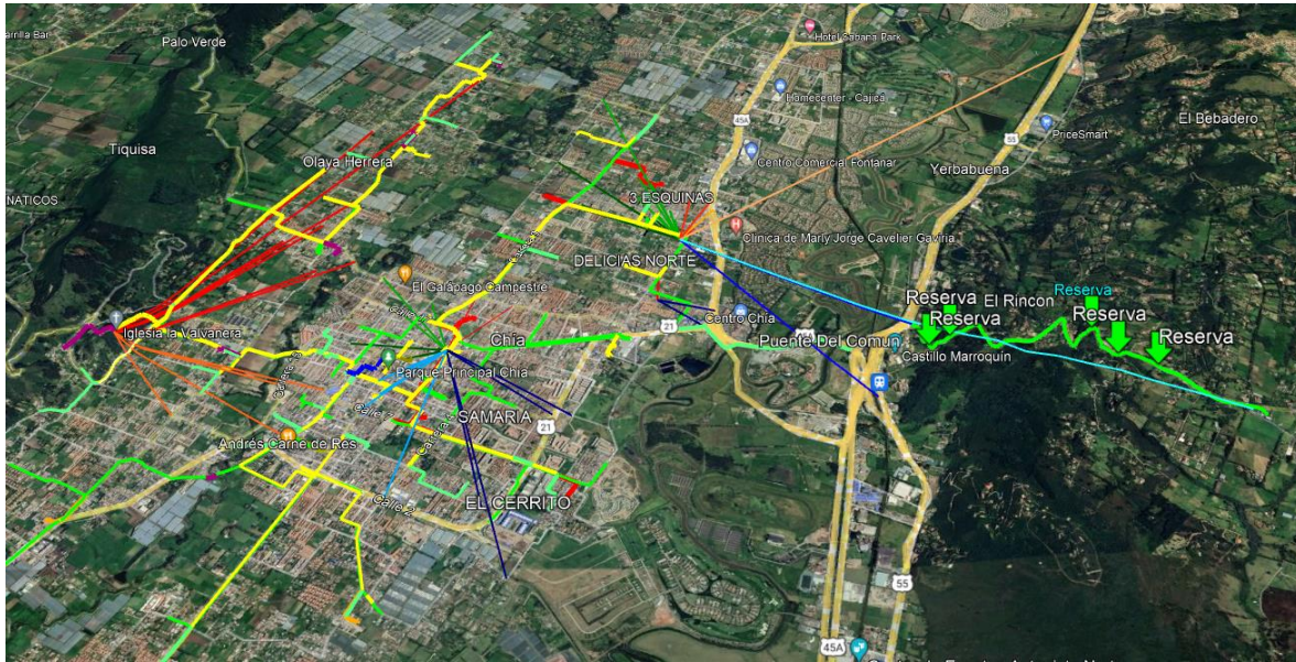
Tendidos de fibra óptica propia en el municipio y radioenlaces.
