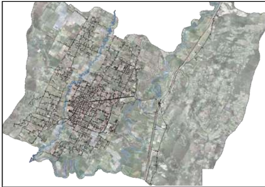
Ilustración 83. Red de acueducto de Emserchía 2015. Fuente Emserchía enero 2016
